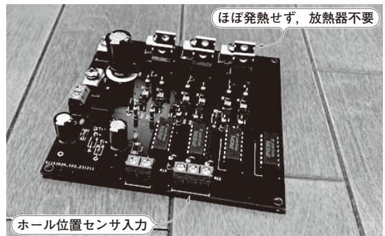
写真4 製作した120° 通電用インバータ
