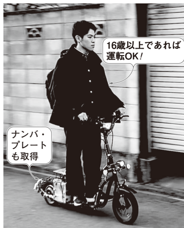
写真1(左) 最大時速20km/ 回生ブレーキ搭載の自作電動キックボード(スクータ)
