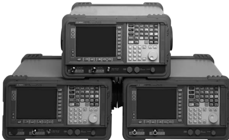
写真2.2 スペクトラム・アナライザの外観(アジレント・テクノロジー ESA-L シリーズ)
