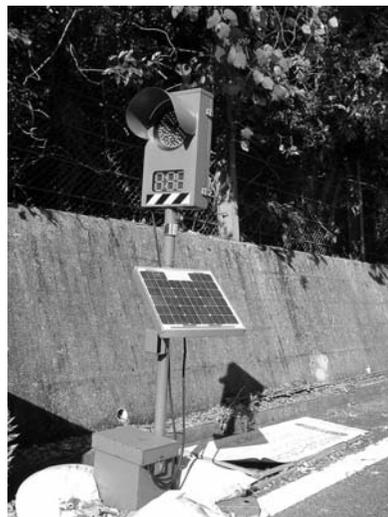
写真0-2 太陽電池を利用した移動式信号機
