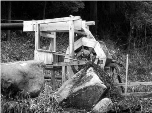
写真0-4 落差をエネルギーに変える発電用上掛け水車
