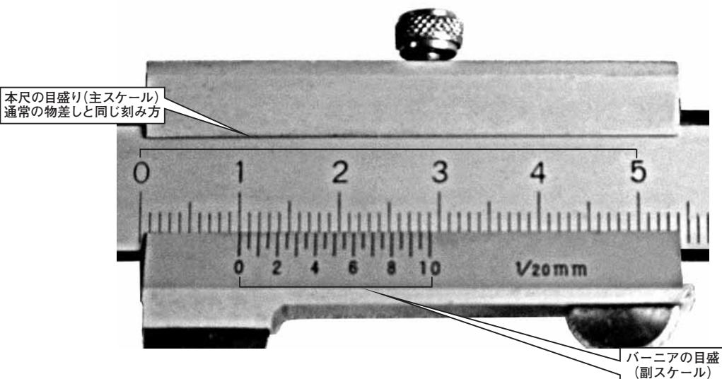
写真は測定値がちょうど 10.00mm を示した状態であるとする。副スケールの目盛は主スケールの 19mm を 20 等分して刻んである。いいかえると、主スケールの  $1/20$  だけ短いスケール間隔になっている。すなわち副スケールの最小目盛の長さは主スケール 1mm より  $1/20$ mm ( $=0.05$ mm) だけ短い。バーニアが右に移動すると副スケールの小さいほうの目盛線から順番に主スケールの目盛線と重なる。副スケールの最小目盛が最初に主スケールの最小目盛 ( $=1$ mm) と重なるとバーニアが右に  $0.05$ mm 移動したことになり被測定物の長さは  $10.05$ mm と読める。以下こうして  $0.05$ mm 単位で被測定物の長さが測定できる。
