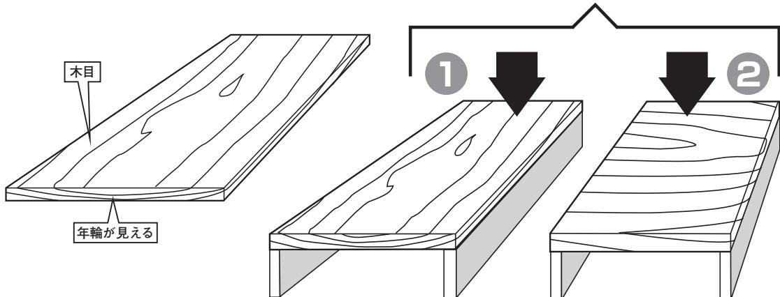
同じような台を作っても、上図のように上部の板の木目の向きは2通りある。①は長さの方向に木目が沿うので見かけは良いが、矢印のような上からの荷重に弱く、折れたり反ったりして強度上よろしくない。②は上部の板の反りを側板が抑えてくれるので強い。
