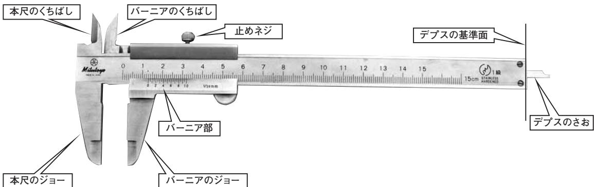
ノギスは広辞苑によるとポルトガルの発明者のラテン名 Nonius がなったものといわれている。写真に見るように、本尺と呼ばれる物差しにバーニアと呼ばれる副尺を組み合わせ、副尺をスライドさせて構造物の寸法を測定するものである。副尺には特別な工夫がしてあり(b)で詳しく説明するが、寸法の測定は3通りある。まず写真に示したように本尺のジョーと呼ばれる腕とバーニアのジョーと呼ばれる腕の間に構造物を挟んで長さや厚さを測るものであり、次に穴の内径のようなものは、本尺のくちばしと呼ばれる突起腕と、バーニアのくちばしと呼ばれる突起腕を穴の内側にさし入れて内径などを測るものである。
