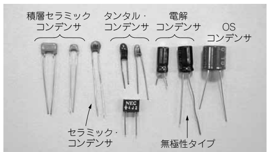
写真1 コンデンサには構造や材質の違いによって多くの種類がある 外形が大きくなると容量、あるいは耐圧が上がる。しかし、形が一定なら、容量と耐圧は反比例の関係にある
