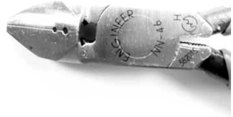
(b) 電線の絶縁被覆は穴開きニッパで剥がす
