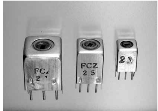
写真1-16 市販の高周波コイルの例(FCZ研究所製)。左から10 mm, 7 mm, 5 mm 角
