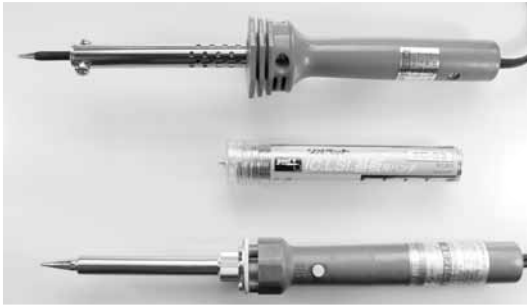
写真1-4 ハンダごて(上・下)とハンダ(中) 上は30W, 下は通常20Wでボタンを押すと130Wで急速加熱できる
