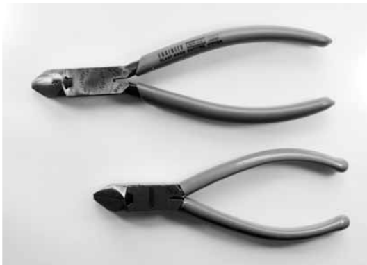
(a) 電子部品のリード線の切断に使う
