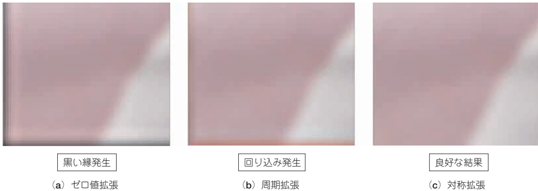
図5.22 各種拡張法による処理結果(左下境界部拡大図)
