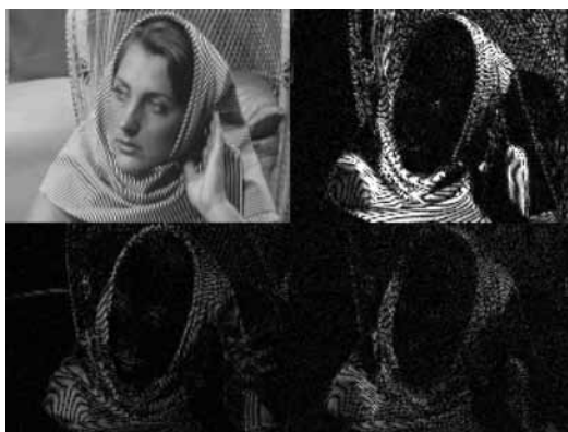
図7.26 図7.3(a)に対する5/3変換後のサブバンド画像
