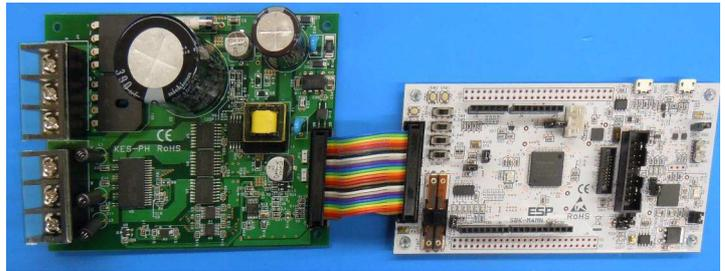
1. 本キットは TMPM4KN マイコン評価ボード SBK-M4KN、交流インバータボード KES-PH のキットです。サンプル・プログラム書込み済ですから、購入したその日にベクトル制御で BLDCモータが回ります。サンプル・プログラムのソースコードは東芝デバイス&ストレージ社のホームページからダウンロードできます。
